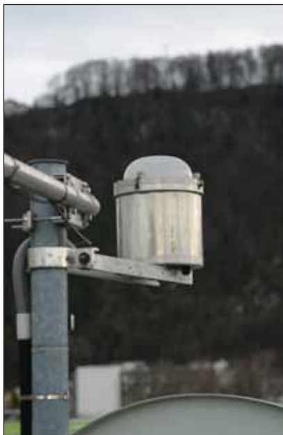
Bild 2. Der beheizte Messtopf mit den Lichtwertaufnehmern
