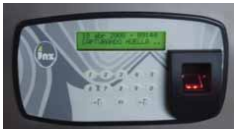
Bild 2. Dank Schnittstelle der Zutrittskontrolle (Fingerprint) zur KNX Anlage ist die bedarfsgerechte Steuerung und Regelung aller Anlagen möglich.
