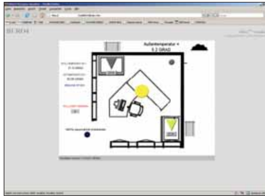
Bild 2. Beispiel für eine individuelle Bedienung der KNX-Anlagen eines Raumes mittels Browser auf dem Arbeitsplatz-PC.
