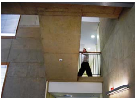
Bild 3. Energieeffizienz 2: Viel Tageslicht und Präsenzmelder für die Beleuchtung. Quelle: Andromeda
