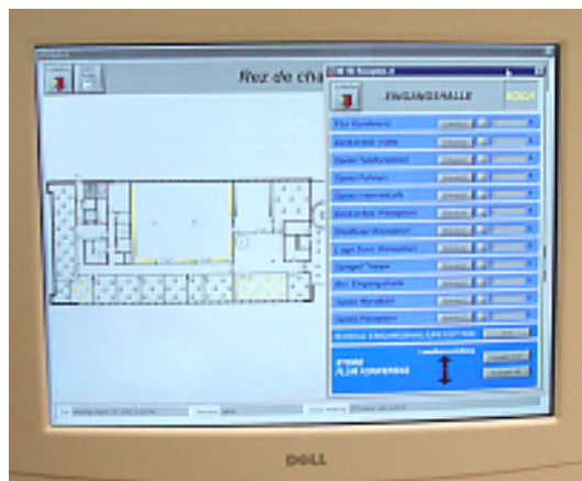
Touch-Panel für die gemeinsame Bedienung der Medien- und EIB-Anlage
