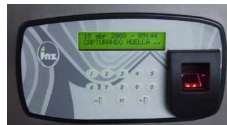
Bild 2 Dank Schnittstelle der Zutrittskontrolle (Fingerprint) zur KNX-Anlage ist die bedarfsgerechte Steuerung und Regelung aller Anlagen möglich. Quelle: ZVG
