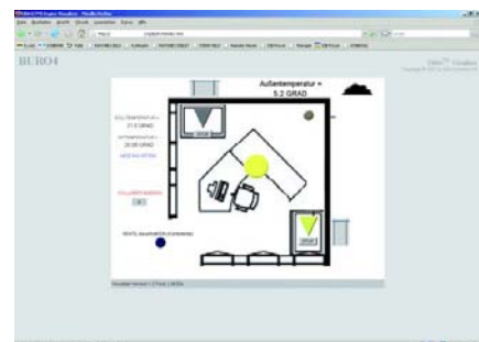
Bild 6. Die Bedienoberfläche für die Raumautomation kommuniziert über Web-Technologie mit der KNX-Anlage. Quelle: Kuhlmann
