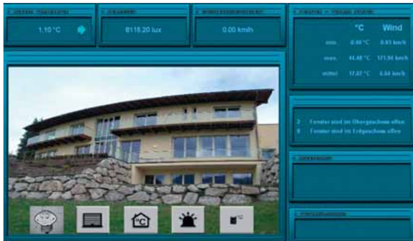
Bild 1. Das geräumige Einfamilienhaus in Brixlegg in der KNX-Visualisierung
